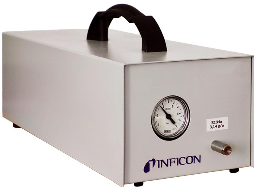
Калиброванные тестовые течи INFICON позволяют тестировать и калибровать течеискатели хладагента, соответствует самым высоким требованиям к качеству обнаружения утечек. Использование тестовых течей и калибровка щуповых течеискателей очень проста. Принцип действия этих течей основан на специальном кварцевом капилляре, который настроен для подачи определенного уменьшенного потока из резервуара с индикаторным газом.
