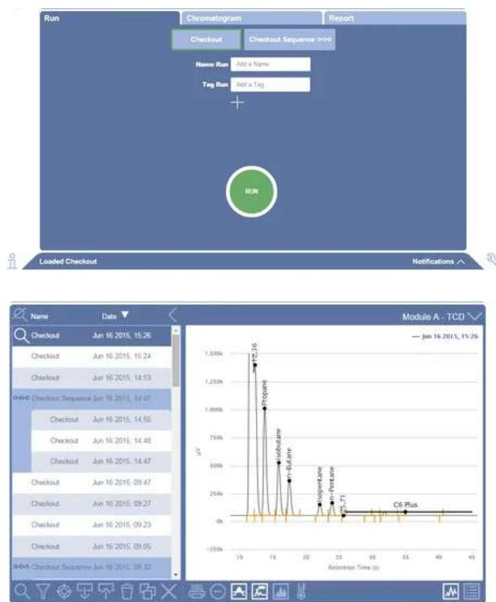
Micro GC Fusion использует пользовательский веб-интерфейс, который обеспечивает несколько новых преимуществ по сравнению с традиционным программным обеспечением. Каждый прибор поставляется со встроенным безлицензионным программным обеспечением, поэтому установка не требуется.
