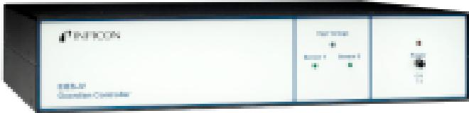
Guardian может контролировать скорость осаждения от 0,1 до 10 000 Å/с. Он управляет одним или двумя датчиками, имеет до 8 оптических входов и контролирует до 8 источников осаждения, что позволяет совмещать до 8 материалов.
