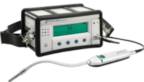
Портативный водородный течеискатель Extrima это полностью безопасный инструмент для применения в самых жестких внешних условиях, включая зону (согласно классификации 1)
