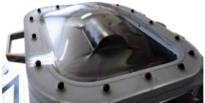
Contura S400 - проверка на герметичность жестяной банки
